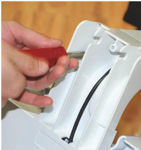
*Figura 3-3. Fijación con los Tornillos*
