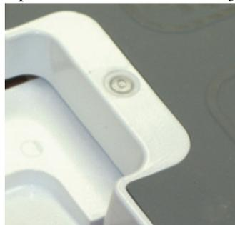
*Figura 3-10. El Nivel de Burbuja Indica el Nivel de la Báscula*
