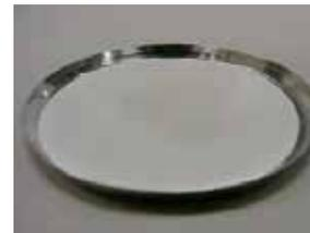
(Antes de la medición) Se goteó 1 g de leche sobre una lámina de fibra de vidrio para mediciones líquidas.
