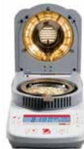
El OHAUS MB23 viene con un elemento de calentamiento por infrarrojos, mientras que el MB25 utiliza tecnología halógena
